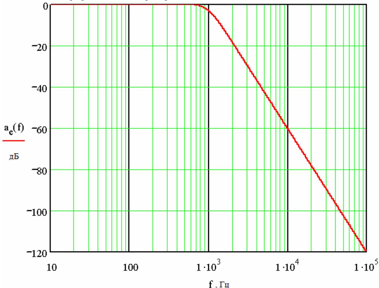
На полученном графике АЧХ отмечается частота среза, определяемая при отклонении АЧХ на -3 дБ от максимального значения коэффициента пропускания фильтра. Крутизна спада АЧХ определяется на линейном участке АЧХ в полосе подавления в децибелах (дБ) при двойном изменении частоты (одна октава). Следует соотнести полученную крутизну спада АЧХ с порядком фильтра.
